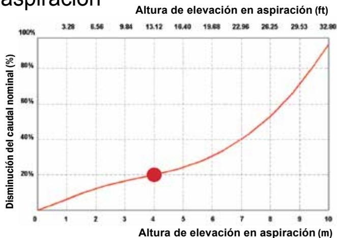
Con una altura de aspiración de 4 m, la bomba disminuye el caudal en alrededor del 20%. Válido para bombas de 3/4" y más grandes; los datos varían dependiendo de la configuración de la bomba.
