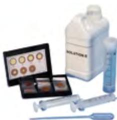
La prueba utiliza un método reactivo: una solución se añade a la muestra de aceite para capturar los cloruros contenidos en esta muestra.
