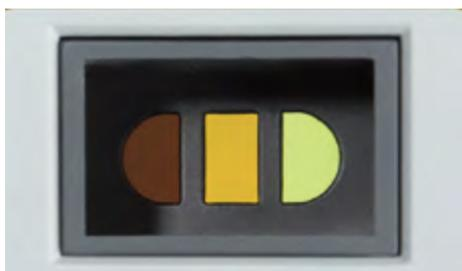
La visualización simultánea de la muestra y dos patrones de color de referencia facilita mucho la gradación de la muestra.
