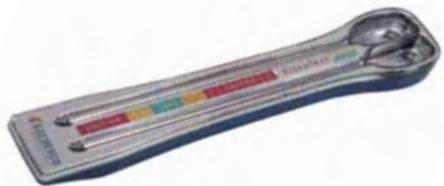
El ViscoTest™ GESERCO permite una comparación fácil y rápida de la viscosidad del aceite usado con el mismo aceite nuevo.
