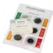
Método comparativo: se deposita una gota de aceite usada en un papel filtro especial en lo cual se extiende y forma una mancha. Se compara con unos patrones de referencia que permite su interpretación.
