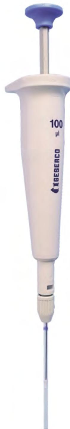
MICROPIPETA TRADICIONAL DE DESPLAZAMIENTO DE AIRE
