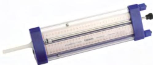
El ViscoBille™ VCD GESERCO permite comparar la viscosidad de cualquier líquido viscoso, con alta sensibilidad y precisión, con dos líquidos de referencia (por ejemplo las viscosidades mínimas y máximas aceptables).
