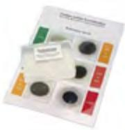
Método comparativo: se deposita una gota de aceite usado en un papel filtro especial, la cual se extiende y forma una mancha. Se compara con unos patrones de referencia que permiten su interpretación.
