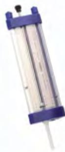
Este viscosímetro con caída de esfera VISCOBILLE™ VCD3T permite la comparación instantánea de la muestra con los estándares de viscosidad mínima y máxima según la norma EN590, incluidos en el kit.
