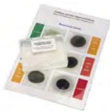
Método comparativo que consiste en colocar una gota de aceite usado en un papel revelador que se convierte en una mancha representativa del contenido de los residuos de la combustión. Unos patrones de referencia permiten la interpretación de la mancha resultante obtenida.
