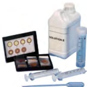
La prueba utiliza un método reactivo: una solución se añade a la muestra de aceite para capturar los cloruros contenidos en esta muestra.
