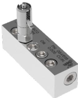
Generalmente, estos indicadores se utilizan para controlar el exceso de presión en las líneas primarias y secundarias. En el caso de que se produzca un aumento excesivo de la presión, saldrá el indicador y permanecerá así hasta que la palanca de liberación no se baje manualmente. Se recomienda investigar la causa y la posición de la avería antes de bajar la palanca.
