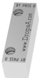
El elemento de by-pass tiene las mismas dimensiones que un elemento dosificador pero sin pistón interno, es decir, sin dosificación. Su función es crear una posición de reserva donde se pueda instalar una válvula dosificadora para aumentar el número de salidas.
