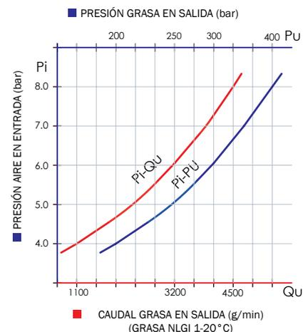
Adecuado para transferir con alta presión grasas y fluidos de alta viscosidad con distancias cortas y largas. El efecto doble asegura la entrega de flujo continuo y constante. Adecuado para los sistemas de distribución centralizados con múltiples puntos de entrega. La presión de trabajo de la bomba puede variar entre un mínimo de 3 bar y un máximo de 8 bar. Para optimizar el rendimiento y la durabilidad de nuestras bombas neumáticas, recomendamos el uso de aire filtrado y lubricado.
