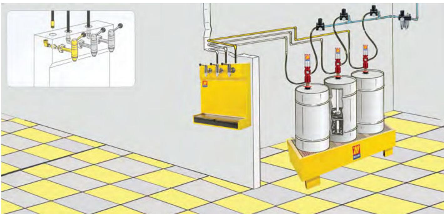
Es una solución alternativa para todos aquellos casos en los que no sean utilizados los enrolladores. Aseguran un suministro práctico, limpio y sin derroches de aceites lubricantes para diferentes empleos. Conectado con una bomba neumática (una para cada grifo), accionando la palanca del grifo estará siempre listo par el uso. Su equipamiento estándar es con un grifo de servicio y predispuesto para otros dos, permitiendo la entrega simultánea de tres diferentes tipos de de fluido.
