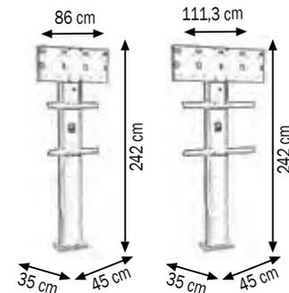
Columnas fijas frontales capaces de proporcionar una estación de trabajo independiente. Permiten una ubicación óptima dentro de los ambientes industriales y garajes. Aseguran un suministro práctico, limpio y sin dilapidaciones de aceites lubricantes para diferentes empleos.
