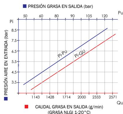
Especialmente adecuado para la transferencia de todos los tipos de grasa, y para el relleno de la unidad de gestión, del cárter, de los lubricadores manuales, donde se requiere la mayor cantidad de grasa con baja presión a corta distancia. La presión de funcionamiento de las bombas de grasa puede variar entre un mínimo de 3,5 bares y un máximo de 8 bar. Para optimizar el rendimiento y la durabilidad de nuestras bombas neumáticas, recomendamos el uso de aire filtrado y lubricado.
