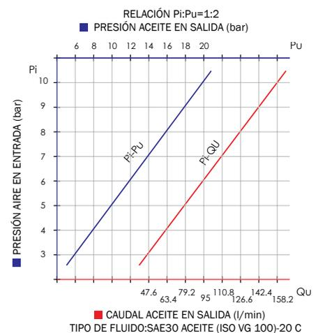
Cuerpo del motor neumático y grupo de inmersión se separan para que el líquido no entre en contacto directo con la carcasa del motor. Adecuado para transferir aceites y fluidos industriales a medianas y largas distancias, garantizan un alto rendimiento tanto como caudal (l / mín) cuanto como presión de uso.
