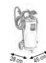
Equipos para nebulización de líquidos detergentes con dispositivo espumoso. Al ser llenados por líquidos para los 3/4 de su capacidad y cargado con aire a 6-8 bar, trabajan en forma independiente, sin necesidad de una conexión continua de aire comprimido.
