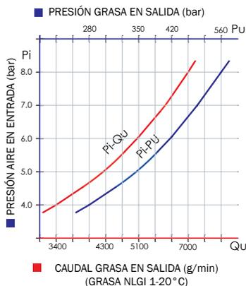
Adecuado para transferir con alta presión grasas y fluidos de alta viscosidad con distancias cortas y largas. El efecto doble asegura la entrega de flujo continuo y constante. Adecuado para los sistemas de distribución centralizados con múltiples puntos de entrega. La presión de trabajo de la bomba puede variar entre un mínimo de 3 bar y un máximo de 8 bar. Para optimizar el rendimiento y la durabilidad de nuestras bombas neumáticas, recomendamos el uso de aire filtrado y lubricado.
