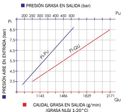
Adecuado para la distribución de alta presión de todos los tipos de grasa ya sea en distancia corta como larga. La presión de trabajo de las bombas de lubricación descritas aquí pueden variar entre un mínimo de 2,5 bar y un máximo de 8 bar. Para optimizar el rendimiento y la durabilidad de nuestras bombas neumáticas, recomendamos el uso de aire filtrado y lubricado.
