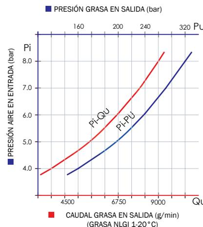
Adecuado para transferir con alta presión grasas y fluidos de alta viscosidad con distancias cortas y largas. El efecto doble asegura la entrega de flujo continuo y constante. Adecuado para los sistemas de distribución centralizados con múltiples puntos de entrega. La presión de trabajo de la bomba puede variar entre un mínimo de 3 bares y un máximo de 8 bar. Para optimizar el rendimiento y la durabilidad de nuestras bombas neumáticas, recomendamos el uso de aire filtrado y lubricado.
