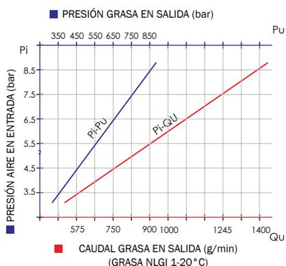
Especialmente adecuado para sistemas de distribución centralizados, donde se requiere una mayor presión en la distancia corta y larga. La presión de funcionamiento de las bombas de grasa puede variar entre un mínimo de 2,5 bar y un máximo de 8 bar. Para optimizar el rendimiento y la durabilidad de nuestras bombas neumáticas, recomendamos el uso de aire filtrado y lubricado.
