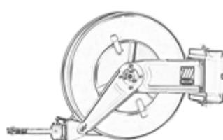
Fijación de pared /techo salida manguera frontal
