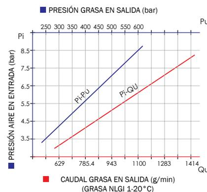
Especialmente adecuado para sistemas de distribución centralizados, donde se requiere una mayor cantidad de graso y mayor presión en la distancia corta y larga. La presión de funcionamiento de las bombas de lubricación puede variar entre un mínimo de 2,5 bar y un máximo de 8 bar. Para optimizar el rendimiento y la durabilidad de nuestras bombas neumáticas, recomendamos el uso de aire filtrado y lubricado.
