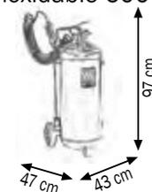
Equipos para nebulización de líquidos detergentes, desinfectantes, lubricantes y similares de baja densidad. Al ser llenados por líquido en los 3/4 de su capacidad y cargado de aire a 6-8 bar, trabajan en forma autónoma, sin necesidad de una conexión continua de aire comprimido.
